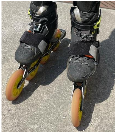
Figura 3.1.1: pattino con solette e sensori Xsens fissati con cinghie di sicurezza
